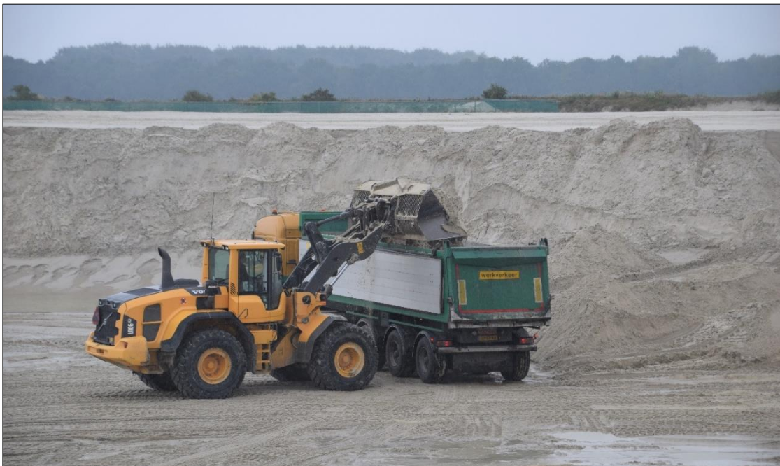
Figuur 8. Er wordt op het zanddepot een shovel ingezet voor het laden van de vrachtwagens of grondkippers.
